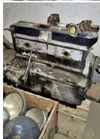
Der Autoverwertungsbetrieb Truninger von aussen. Aus dem Lager für Oldtimermotoren sind Triebwerke aus den Jahren 1900 bis 1940 sofort lieferbar. Im Bild ein 6-Zylinder-Schiebermotor von Voisin.
